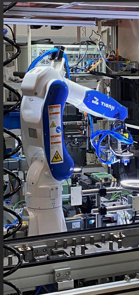
▲ 汽车雷达组装检测
